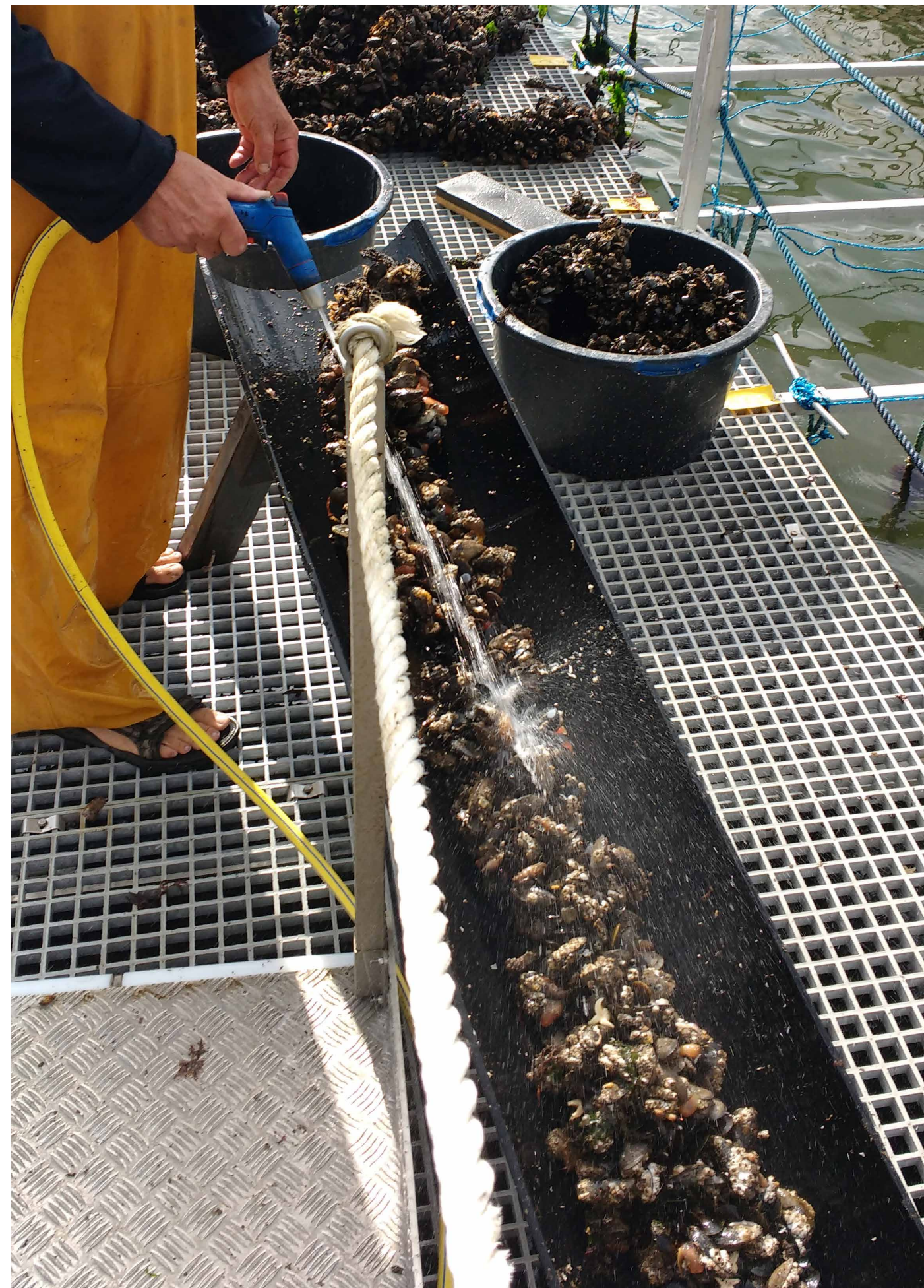
Foreningerne opfinde meget at værktøjet selv. Her er det en sliske lavet af pvc rør, der bruges til at holde styr på muslingerne, mens de bliver spulet for begroinger.
