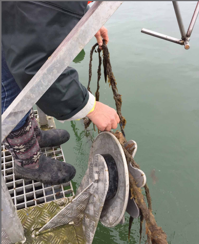
Arbejdsplatform med spil til ophaling af hovedline og stjernejul.
