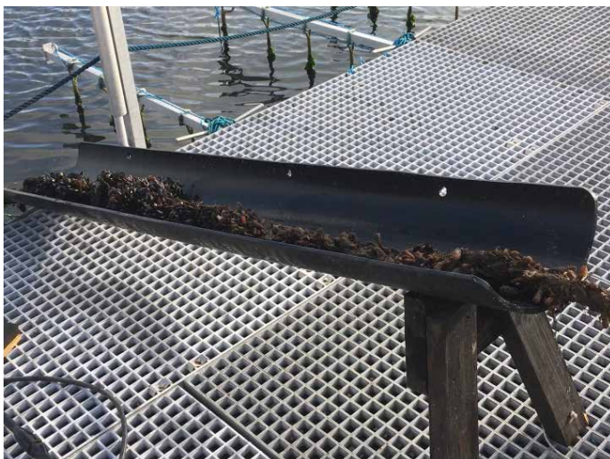
Transportabel rensesliske til rensning af muslingestrømper. På billedet nedenfor ses anvendelsen af en højtryksrenser, der bruges til at fjerne uønskede organismer.
