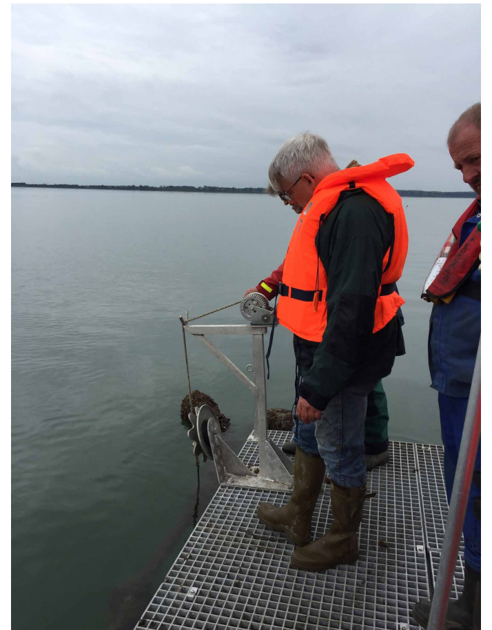
Spil og stjernehjul der gør det muligt at gribe hovedlinen og fastgøre den på stjernehjulet, så man kan transportere sig langs linen uden brug af motor.
