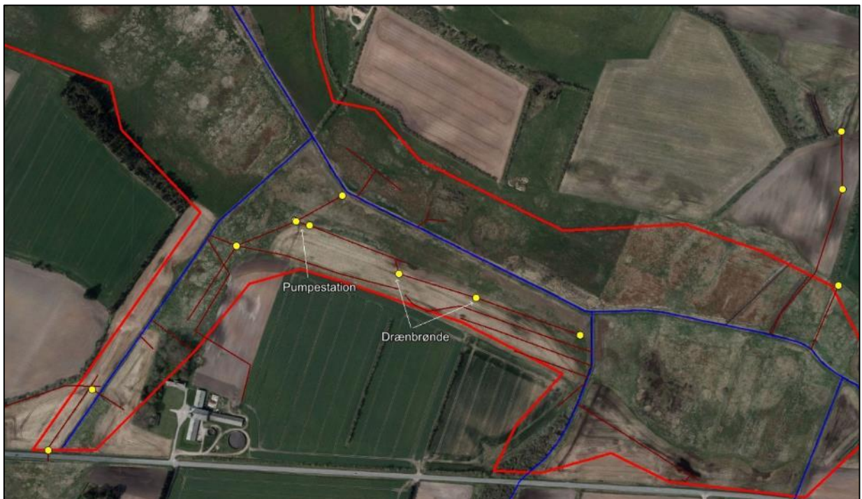
Figur 28. Pumpestation og tilhørende ledninger og drænbrønde.
